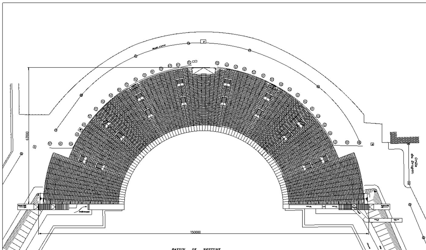
Le gradin a été conçu pour intégrer la forme du bassin NEPTUNE dans les jardins du château de VERSAILLES. L'ouvrage est démontable pour ne pas modifier durablement l'aspect général du site. Le gradin doit rester en place quelques semaines durant l'été.
